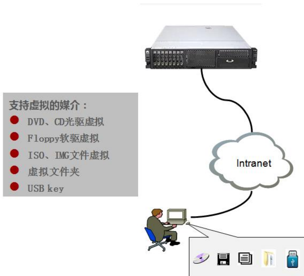
图 3-43 虚拟媒体实现原理
