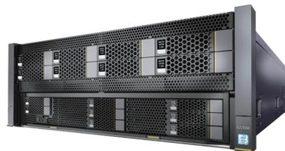
FusionServer G5500采用全模块化和异构解耦的系统设计，提供全宽和半宽两种异构计算节点，支持PCIe GPU等多种类型的异构加速卡。
